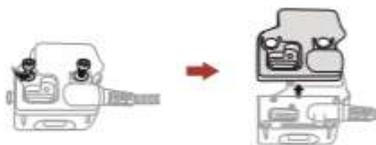
3. ラバーパッドを取り外し、パッケージに入っているより厚いラバーパッドに交換します。
